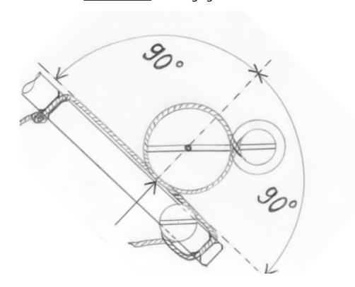
Die Fixierschraube wird in das zweite Gewinde eingesetzt, nicht in das zuvor in der Ausgangsstellung verwendete.
