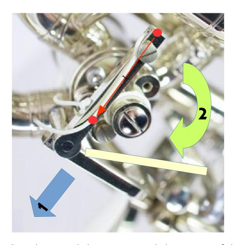
Tipp (optional): An diesem Punkt kann man, um sich das spätere Einfädeln durch die dünnen Löcher einfacher zu machen, das lose Ende der Schnur mit etwas Heißem (z. B. Lötkolben) zusammenschmelzen, um das Aufspleißen der Schnur bei den Einfädelversuchen zu verhindern.
